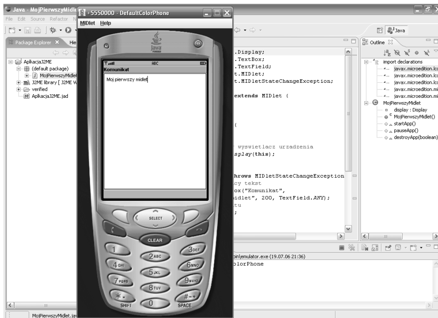
Rysunek 6 – Uruchomienie aplikacji mobilnej J2ME na emulatorze urządzenia
